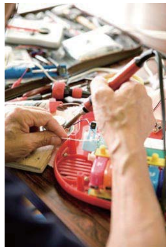
写真3 修理現場：ハンダ付けはおもちゃドクターとして必須の技術
