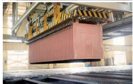
写真1 粗銅のアノード (上 鑄造中、下 できあがったアノード) (協力:パンパシフィック・カッパー(株))
