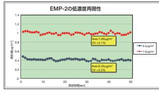
図3 EMP-2で測定した低濃度再現性
