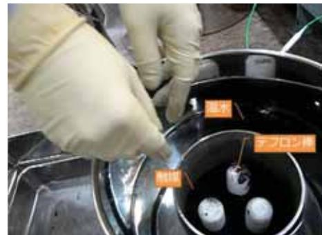
図2 触媒洗浄の様子
