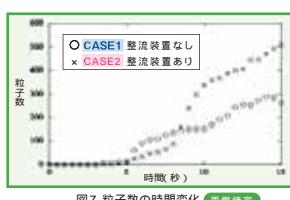
図7 粒子数の時間変化 再燃焼室
