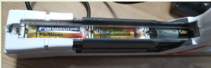
電池の液漏れ
