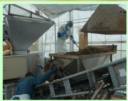
⑤水分調節のため戻し堆肥等を混ぜる作業（1）
