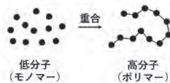
図1 高分子（ポリマー）の一般的な作り方
