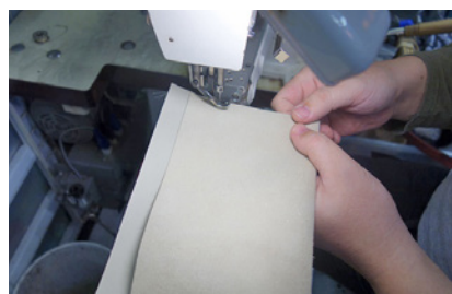
4 ミシンで縫製し、内側に取り付ける。
