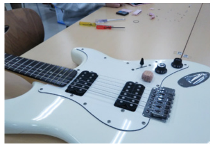
写真4 木製のツマミを自作して修理したエレキギター
