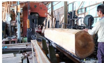
写真2 地産スギ材の製材風景（奈良県）
