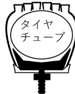
図3 ビードストッパーの役割：タイヤのビード（耳）を、リム（車輪）に押しつけて、ずれるのを防ぐ
