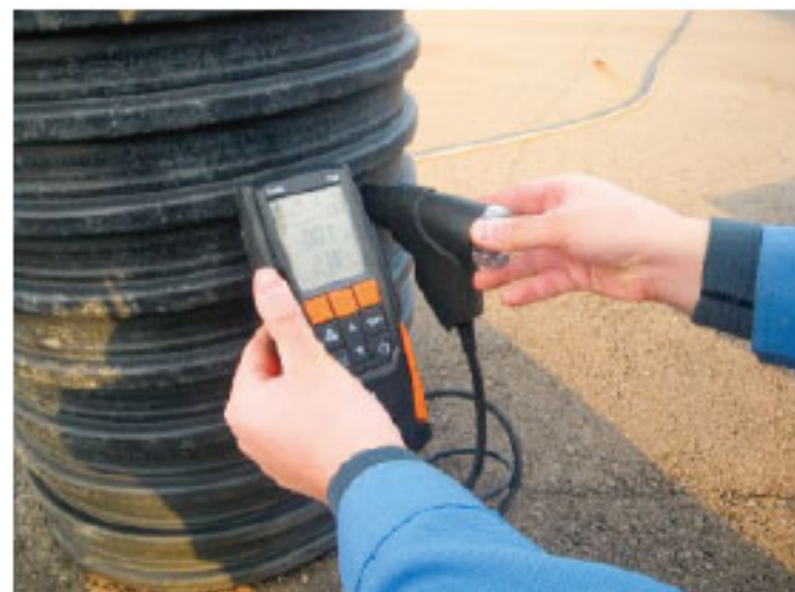
図4-9 埋立ガスの採取方法と測定状況 (例)
