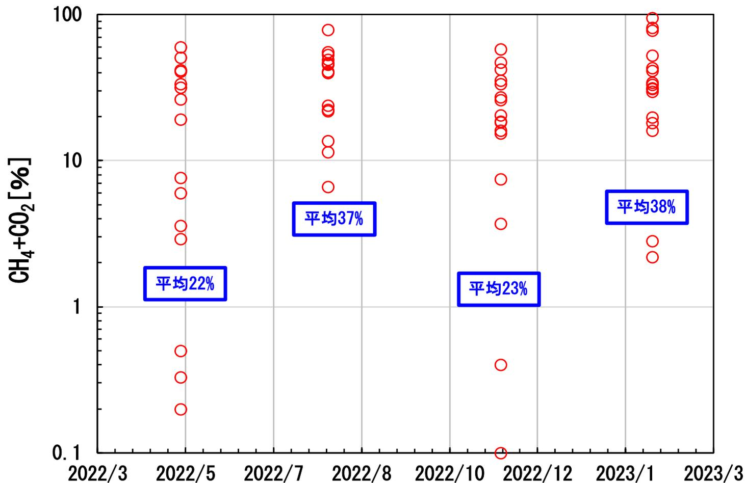
ガス抜き管の変動が大きい・季節変動が大きい
