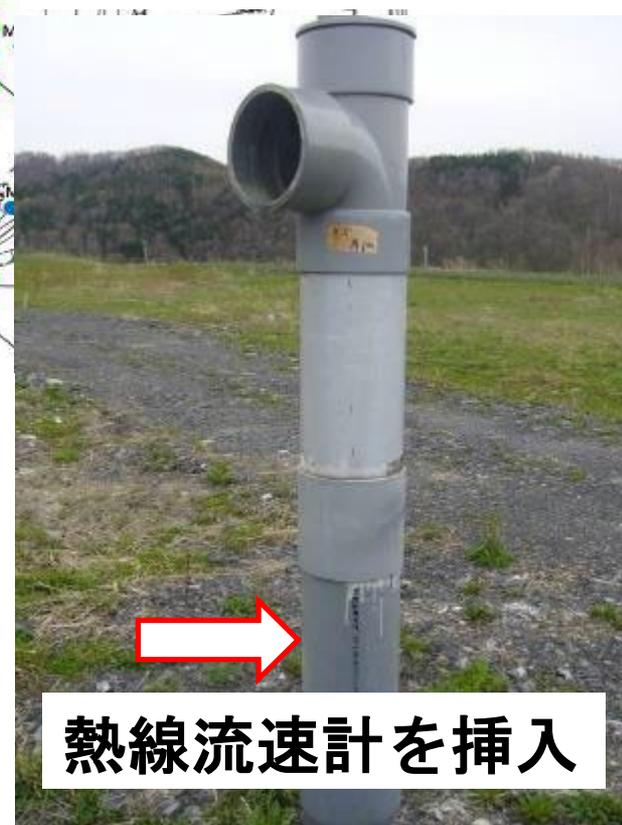
ガス抜き管測定概要
