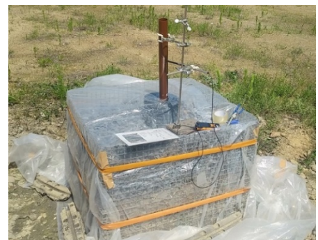
通気装置等でのガス流速の測定風景
