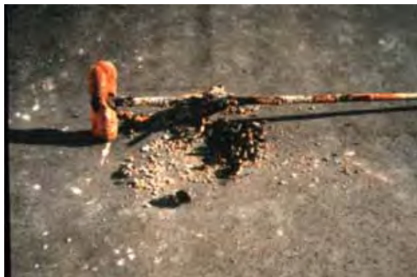
写真 1 攪拌機に付着したスケール
