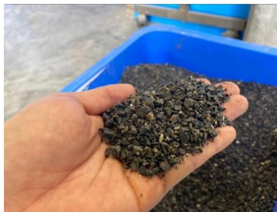
脱塩後のプラスチックのイメージ (プラスチック溶融破砕物)
