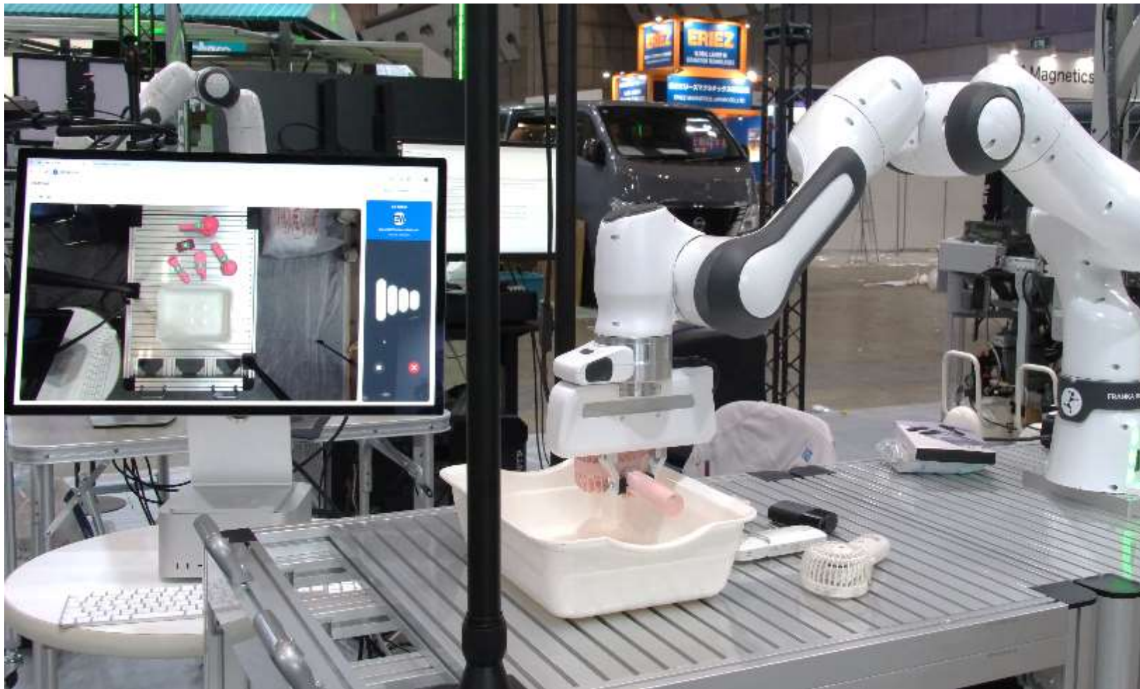
写真 ロボットへの会話指示で小型扇風機を選別回収（展示：NEW環境展）
