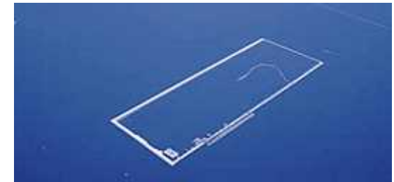
外海から遮水護岸で隔離した水面区画を作って環境保全上の支障が生じないようにした埋立区画（処分場）
