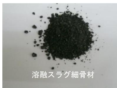
再生資材としては、高炉スラグ細骨材や溶融スラグ細骨材を使用しています。高炉スラグ細骨材は製鐵製造時に発生する溶融固化物を、溶融スラグ細骨材は一般廃棄物を溶融炉が焼却した時に発生する溶融固化物を砂状に加工したものであります。一部の製品では、これらのスラグ細骨材を購入して、コンクリートの原材料である細骨材（砂）の一部を置換したコンクリート製品を製造しています。高炉スラグ細骨材や溶融スラグ細骨材を使用することで天然資材である砂の使用量削減効果があり、環境負荷の低減が図れると考えています。
