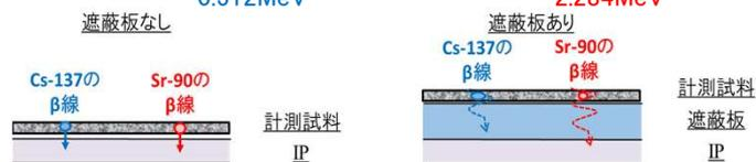
両方のβ線がIPに到達 エネルギーの低いCsのβ線が大きく減衰
