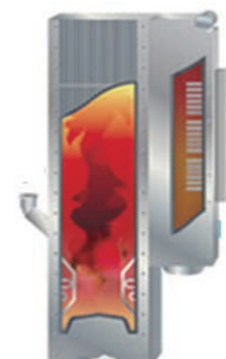
ICFB 内部循環流動床ボイラ
