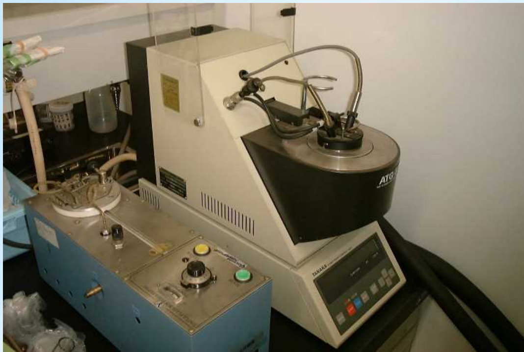
引火点測定装置(写真左:セタ式、右:タグ密閉式)
