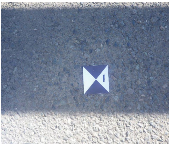
図4 標定点測量実施状況（左図：設置した標定点，右図：測量状況）
