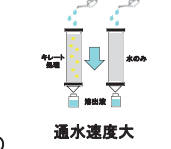
キレート処理飛灰(左)と水混練飛灰(右)
