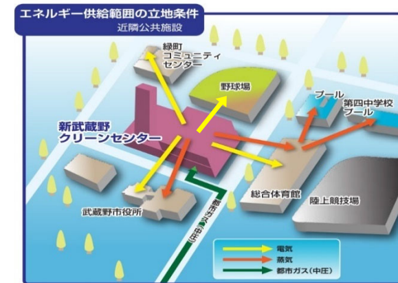
公共施設のエネルギー供給拠点
